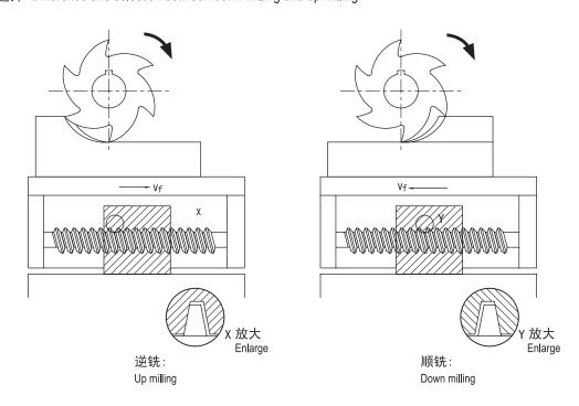
顺铣: 铣刀与工件接触部分的旋转方向与切削进给方向相同的铣削方式。
